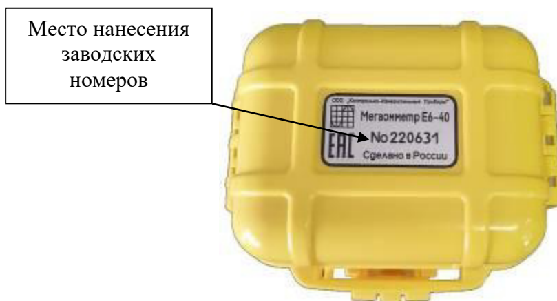
Рисунок 4 – Обозначение места нанесения заводских номеров на мегаомметры Е6-40, Е6-41
