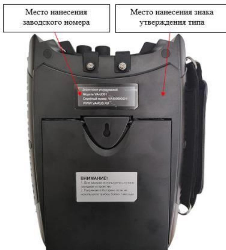
Рисунок 2 - Общий вид задней панели средства измерений
