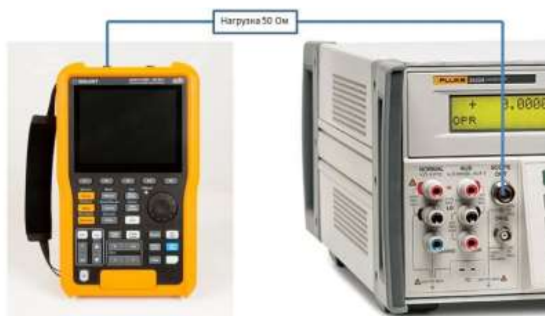
Рисунок 2 – Схема соединения приборов при определении времени нарастания переходной характеристики и определении относительной погрешности частоты внутреннего опорного генератора.
