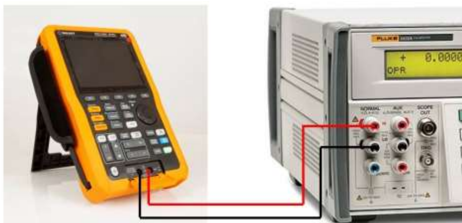
Рисунок 3 – Схема соединения приборов при определении погрешности измерения напряжения постоянного и переменного тока, электрического сопротивления постоянному току, электрической емкости
