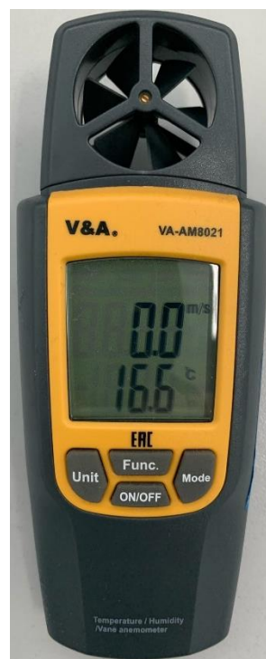
Рисунок 4 - Анемометр крыльчатый VA модели VA-AM8021 без защитной крышки
