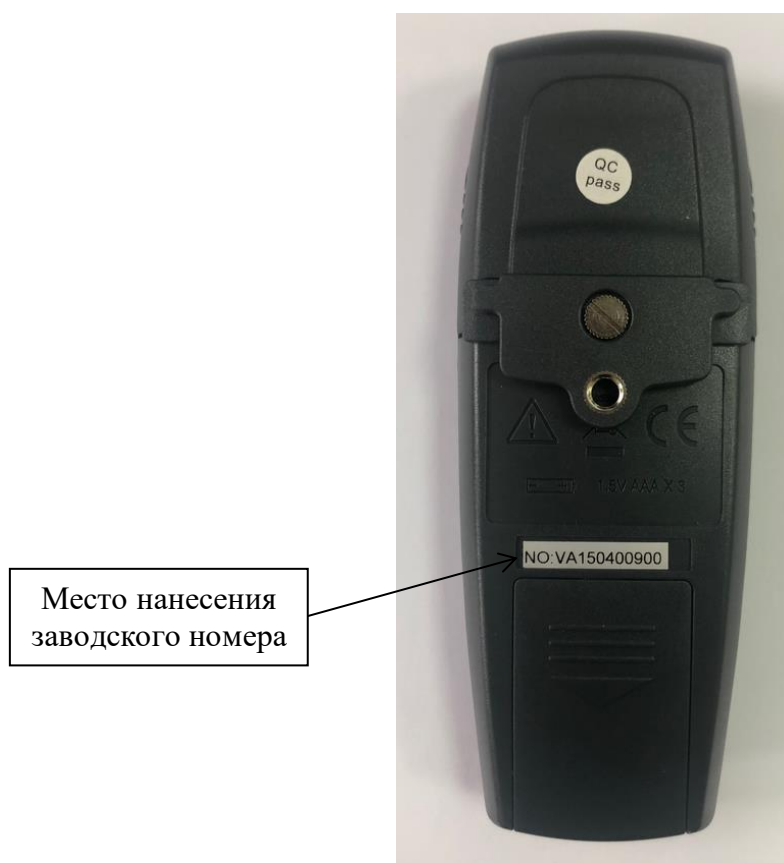
Рисунок 5 – Место нанесения заводского номера анемометра крыльчатого VA
