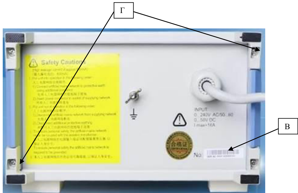
Рисунок 2 – Вид задней панели эквивалентов сети с местами нанесения наклейки с серийным номером (В) и пломбировки (Г)
