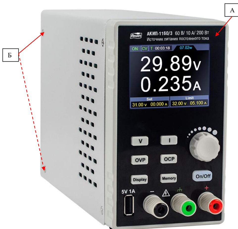
Рисунок 1 – Общий вид источников, места нанесения знака утверждения типа (А) и пломбировки (Б)
