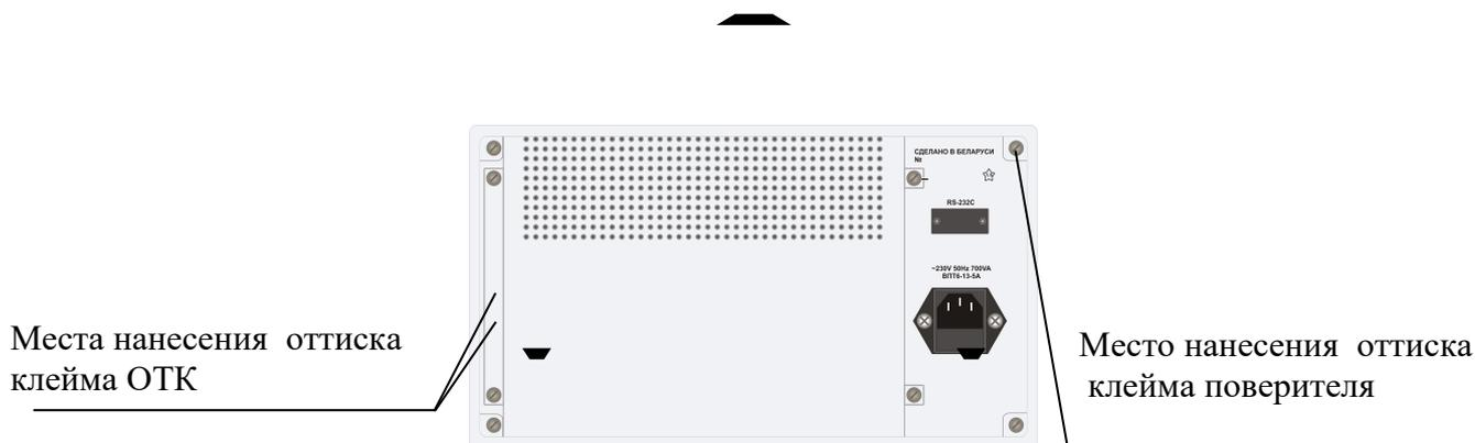
Рисунок 2 – Места нанесения оттиска клейма поверителя и оттиска клейма ОТК (вид источника питания сзади)
